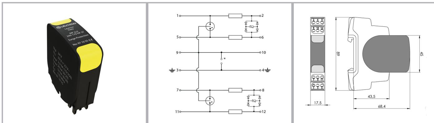
Steckmodul für den durchgängig steckbaren, zweiteiligen Ableiter für Signalkreise mit hohen Frequenzen wie Bussystemen oder Videoübertragung. Das Modul kann für Prüf- und Wartungszwecke impedanzneutral gezogen werden. Das Basisteil (Zubehör) verbleibt in der Installation, wodurch nicht in die Verkabelung eingegriffen werden muss.
