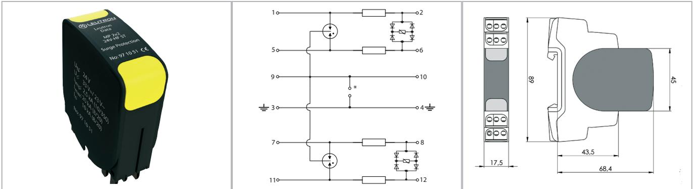
Steckmodul für den durchgängig steckbaren, zweiteiligen Ableiter für Signalkreise mit hohen Frequenzen wie Bussystemen oder Videoübertragung. Das Modul kann für Prüf- und Wartungszwecke impedanzneutral gezogen werden. Das Basisteil (Zubehör) verbleibt in der Installation, wodurch nicht in die Verkabelung eingegriffen werden muss.
