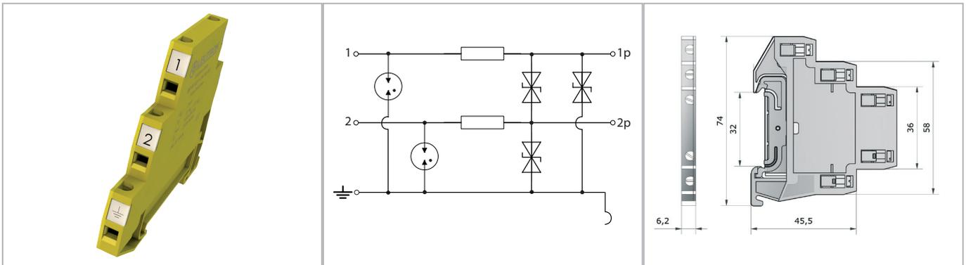
Reihenklemme mit integriertem Überspannungsschutz zur Optimierung des Platzbedarfes im Schaltschrank bei gleichzeitigem bestmöglichem Schutz der Geräte und Systeme.
