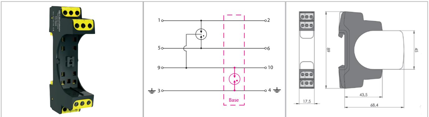
**Indirekte Schirmerdung bei MP Base 1x2 GDT: die Anschlüsse 9/10 (GND) sind über einen Gasableiter mit dem Montagefuß und dem Erdungsanschluss verbunden und können somit galvanisch von PE getrennt werden. Basiselement zur Aufnahme eines MP-Moduls.**
