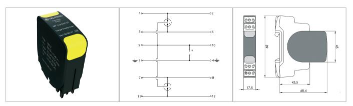
Durchgängig steckbarer, zweiteiliger Ableiter für Signalkreise, wodurch Stecker für Prüf- und Wartungszwecke impedanzneutral gezogen werden kann. Das Basisteil verbleibt in der Installation, wodurch nicht in die Verkabelung eingegriffen werden muss.
