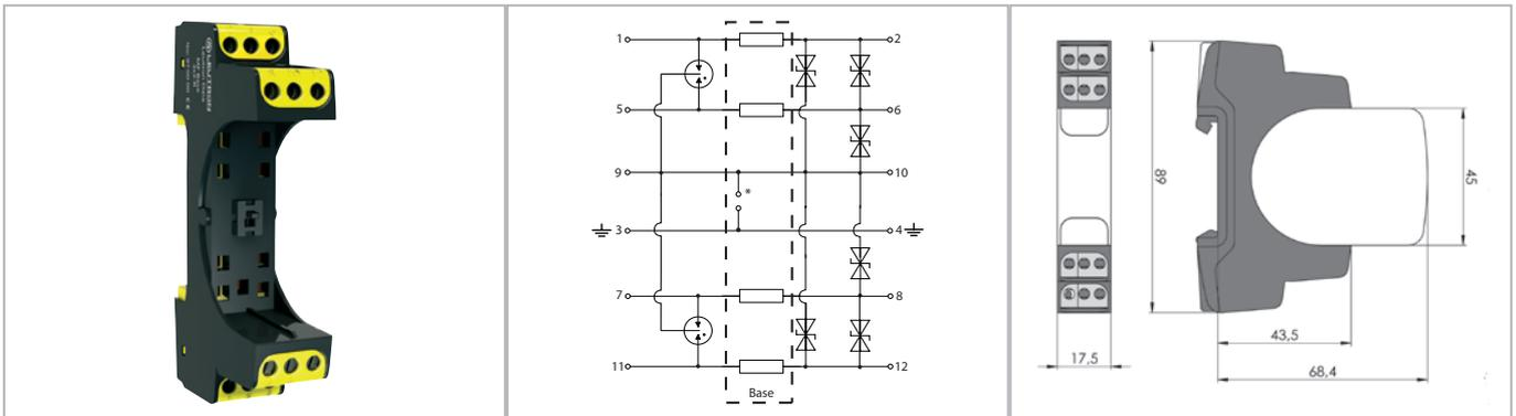
Beim MP Base 2x2-R sind die Anschlüsse 9/10 (GND) nicht mit dem Montagefuß verbunden. Galvanische Trennung PE.
