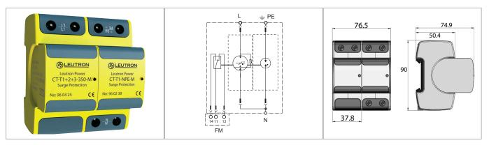
Kombi-Ableiter mit sehr niedrigem Schutzpegel von kleiner 1,0 kV für einphasige TT- und TN-Systeme auf Basis gasgefüllter Funkenstrecken. Diese ermöglichen ein extrem hohes Ableitvermögen bei gleichzeitig niedrigem Schutzpegel und benötigen keine empfindliche interne oder externe Triggerelektronik.
