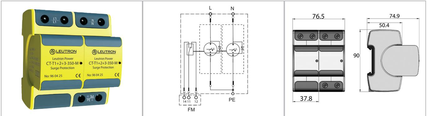
**Kombi-Ableiter mit sehr niedrigem Schutzpegel von kleiner 1,0 kV für einphasige TN-Systeme auf Basis gasgefüllter Funkenstrecken. Diese ermöglichen ein extrem hohes Ableitvermögen bei gleichzeitig niedrigem Schutzpegel und benötigen keine empfindliche interne oder externe Trigger-elektronik.**
