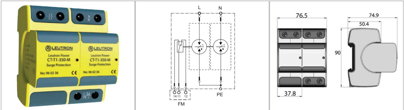
Blitzstromableiter für einphasige TN-Systeme auf Basis gasgefüllter Funkenstrecken. Diese ermöglichen ein extrem hohes Ableitvermögen bei gleichzeitig niedrigem Schutzpegel und benötigen keine empfindliche interne oder externe Triggerelektronik.
