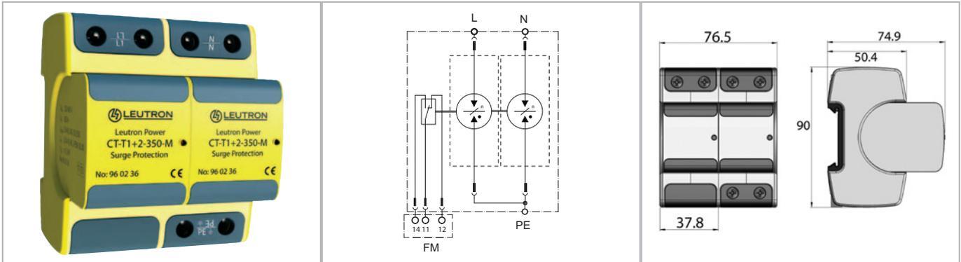
**Blitzstromableiter mit sehr niedrigem Schutzpegel von kleiner 1,5 kV für einphasige TN-Systeme auf Basis gasgefüllter Funkenstrecken. Diese ermöglichen ein extrem hohes Ableitvermögen bei gleichzeitig niedrigem Schutzpegel und benötigen keine empfindliche interne oder externe Triggerelektronik.**
