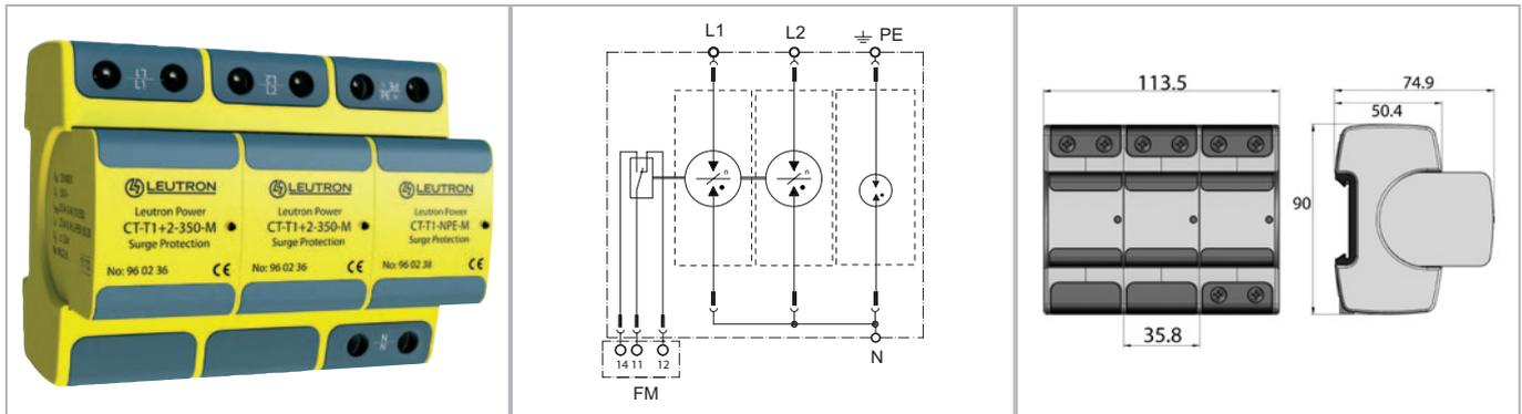
**Blitzstromableiter mit sehr niedrigem Schutzpegel von kleiner 1,5 kV auf Basis gasgefüllter Funkenstrecken für 2-phasige TT-Systeme. Diese ermöglichen ein extrem hohes Ableitvermögen bei gleichzeitig niedrigem Schutzpegel und benötigen keine empfindliche interne oder externe Triggerelektronik.**
