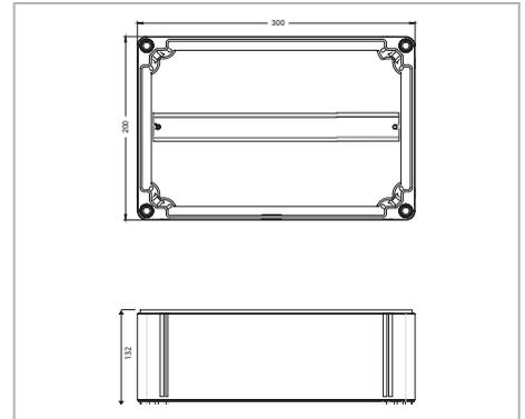
Generatoranschlusskasten mit Sicherungshaltern zur Aufnahme von DC-Stringsicherungen auf der Plus- und Minusseite. Bei PV-Anlagen zum Schutz der Wechselrichter mit einem MPP-Tracker.
