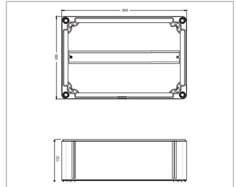
Generatoranschlusskasten mit Sicherungshaltern zur Aufnahme von DC-Stringsicherungen auf der Plus- und Minusseite. Bei PV-Anlagen zum Schutz der Wechselrichter mit einem MPP-Tracker.
