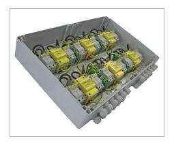
Generatoranschlusskasten mit Sicherungshaltern zur Aufnahme von DC-Stringsicherungen auf der Plus- und Minusseite. Bei PV-Anlagen zum Schutz der Wechselrichter mit sechs MPP-Trackern.
