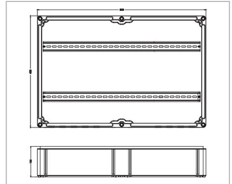
Generatoranschlusskasten mit Sicherungshaltern zur Aufnahme von DC-Stringsicherungen auf der Plus- und Minusseite. Bei PV-Anlagen zum Schutz der Wechselrichter mit vier MPP-Trackern.
