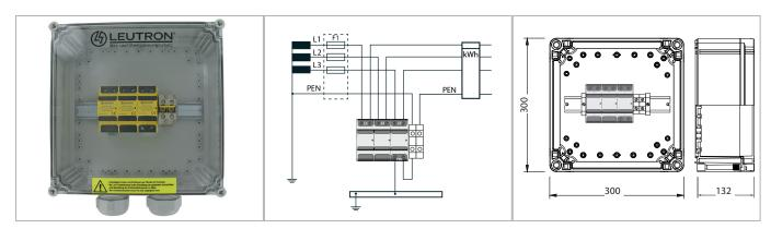
Anschlusskasten im Vorzählerbereich für 3-phasige TNC-Netze nach DIN VDE 0100-443 und -534. Kombi-Ableiter mit sehr niedrigem Schutzpegel von kleiner 1,0 kV auf Basis gasgefüllter Funkenstrecken. Einsatz im ungemessenen Vorzählerbereich nur nach Absprache mit dem Netzbetreiber.
