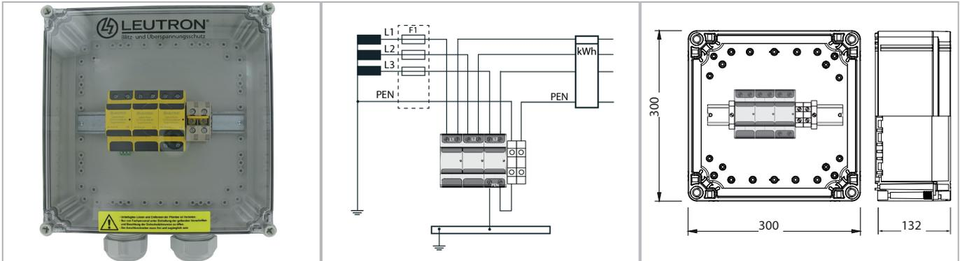
**Anschlusskasten im Vorzählerbereich für 3-phasige TNC-Netze nach DIN VDE 0100-443 und -534. Kombibleiter mit sehr niedrigem Schutzpegel von kleiner 1,5 kV für dreiphasige TNC-Systeme auf Basis gasgefüllter Funkenstrecken. Einsatz im ungemessenen Vorzählerbereich nur nach Absprache mit dem Netzbetreiber.**
