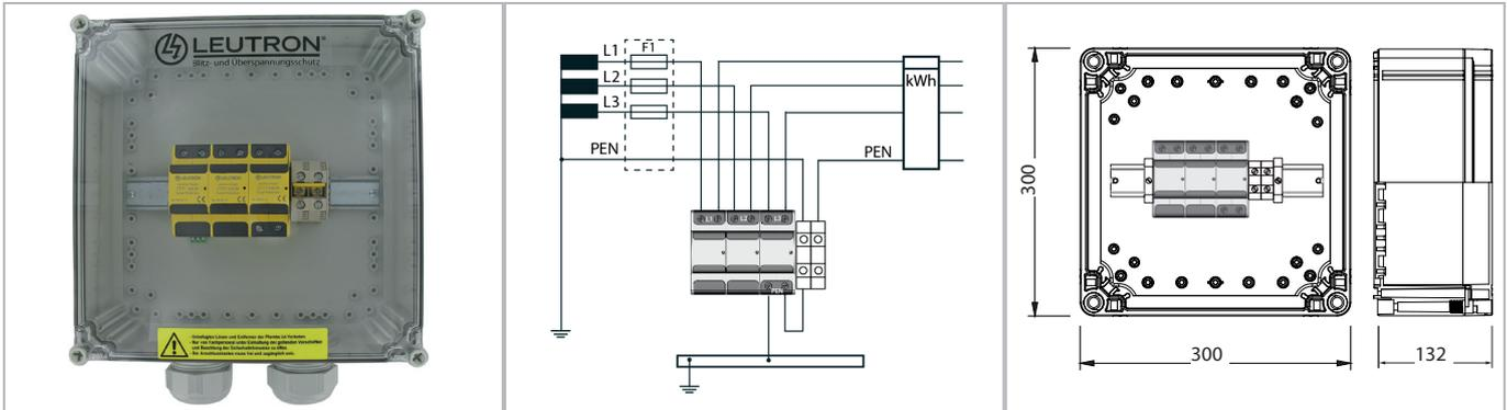
**Anschlusskasten im Vorzählerbereich für 3-phasige TNC-Netze nach DIN VDE 0100-443 und -534. Blitzstromableiter für dreiphasige TNC-Systeme auf Basis gasgefüllter Funkenstrecken. Einsatz im ungemessenen Vorzählerbereich nur nach Absprache mit dem Netzbetreiber.**
