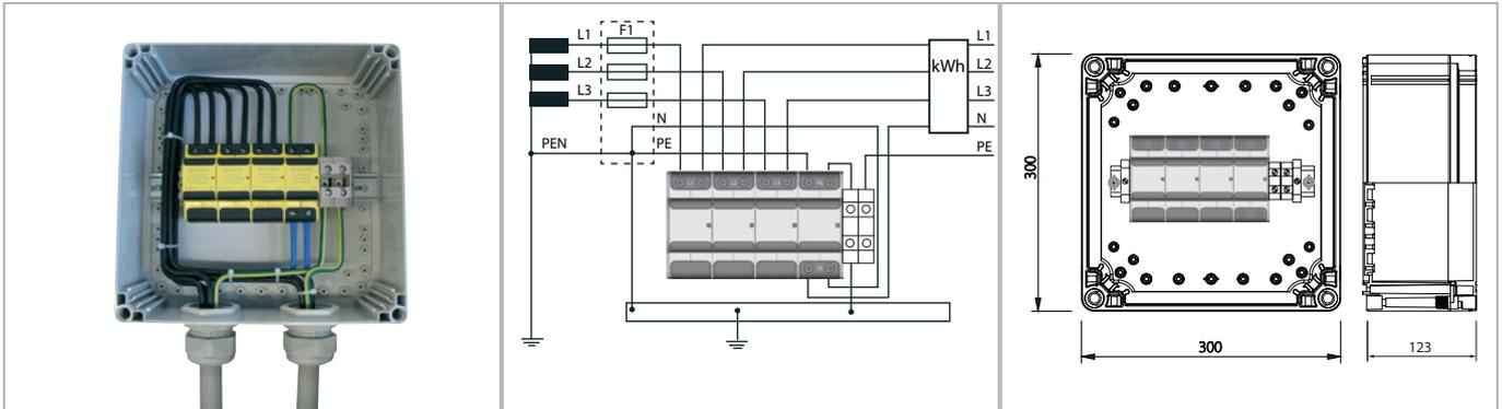
Anschlusskasten im Vorzählerbereich für 3-phasige TT- oder TNS-Netze nach DIN VDE 0100-443 und -534. Kombi-Ableiter mit sehr niedrigem Schutzpegel von kleiner 1,0 kV auf Basis gasgefüllter Funkenstrecken. Diese ermöglichen ein extrem hohes Ableitvermögen bei gleichzeitig niedrigem Schutzpegel und benötigen keine empfindliche interne oder externe Triggerelektronik. Einsatz im ungemessenen Vorzählerbereich nach Absprache mit dem Netzbetreiber.
