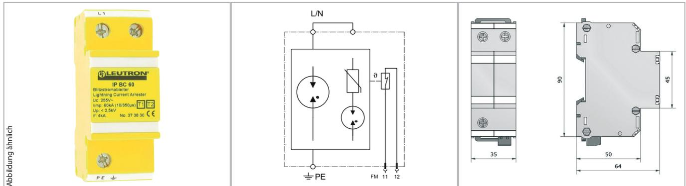
Einpoliger Kombi-Ableiter Typ 1 + 2 für den Blitzschutzpotentialausgleich in ein- bzw. mehrpoligen TN- Netzsystemen.
