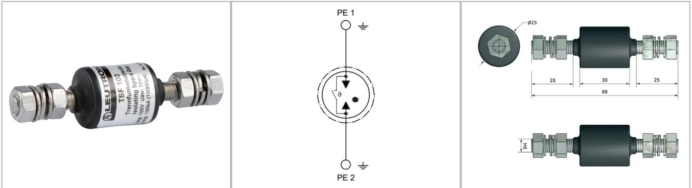
Edelgasgefüllte Trennfunkens-*strecke* zum Blitzschutz-Potenzialausgleich, zur Isolierung von potentialgetrennten Anlagenteilen und zur Überbrückung von Isolierflanschen bei Gaspipelines. Zur Anwendung im Gebäudeinneren oder ähnlichen geschützten Umgebungen.
