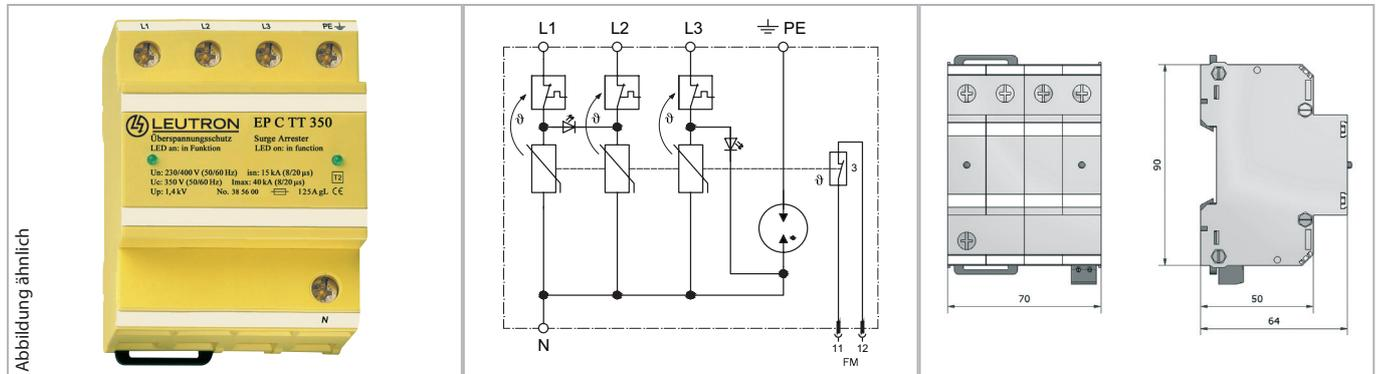
Viervoliger, kompakter und leckstromfreier Überspannungsableiter z. B. für ein 3-phasiges TT- und TN-S-System.
