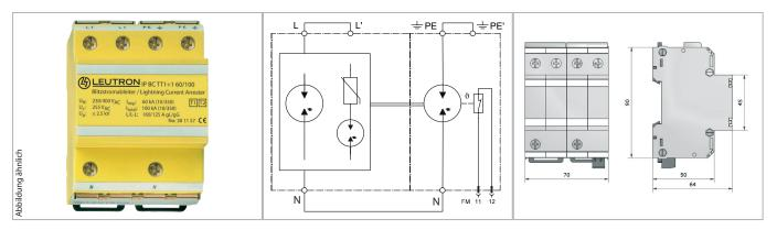
Mehrpoliger Kombi-Ableiter für 1-phasige TT-Systeme. Die Ableiter sind nach dem Blitzschutzzonen-Konzept an den Schnittstellen 0A-2 einsetzbar.
