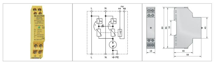
Zweipoliger, kompakter Überspannungsableiter Typ 3 für den Einsatz in TN-Netzen. Einsetzbar nach dem Blitzschutzzonen-Konzept an den Schnittstellen 2-3.
