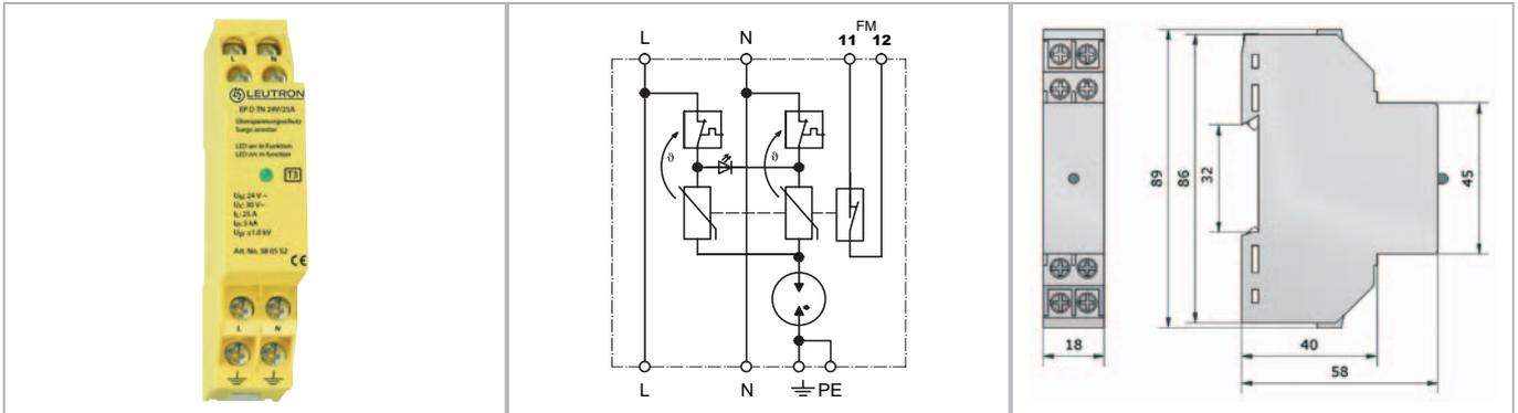
Zweipoliger, kompakter Überspannungsableiter Typ 3 für den Einsatz in TN-Netzen. Einsetzbar nach dem Blitzschutz-zonen-Konzept an den Schnittstellen LPZ 2-3.
