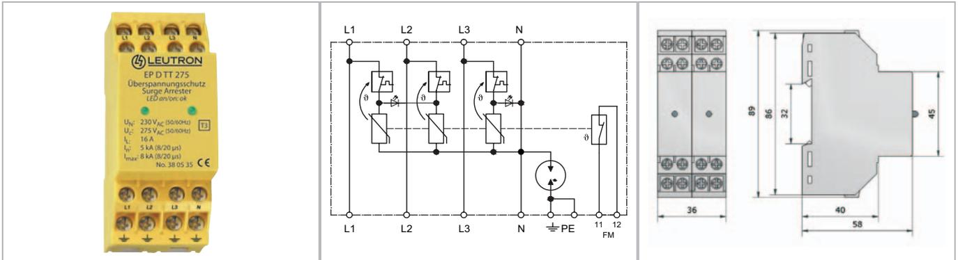
**Viervoliger, kompakter Überspannungsableiter z. B. für 3-phasige TT- und TN-S-Systeme. Einsetzbar nach dem Blitzschutz-zonen-Konzept an den Schnittstellen LPZ 2-3.**
