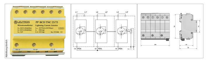
Dreipoliger Kombi-Ableiter für 3-phasige TNC-Systeme. Der Einsatzort des PowerPro BCD ist die Hauptverteilung vor oder nach dem Zähler. Er kann entsprechend dem Blitzschutzzonen-Konzept nach VDE 0185-305-1-4 (IEC DIN EN 62305 Teil 1-4) an den Schnittstellen 0A bis 2 universell eingesetzt werden.
