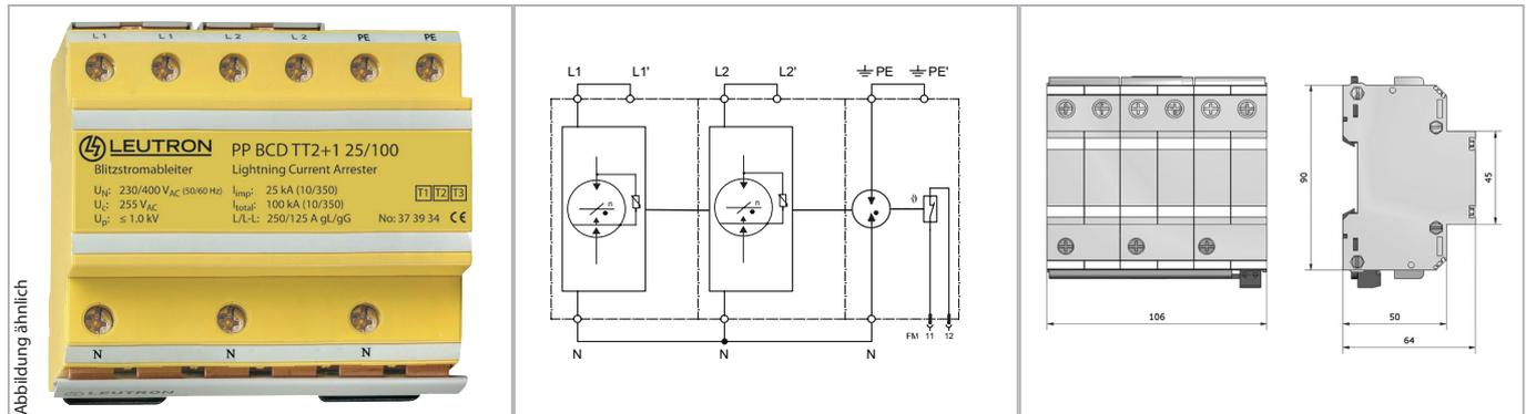
Mehrpoliger Kombi-Ableiter für 2-phasige TT-Systeme. Der Einsatzort des PowerPro BCD ist die Hauptverteilung vor oder nach dem Zähler. Er kann entsprechend dem Blitzschutzkonzept nach VDE 0185-305-1-4 (IEC DIN EN 62305 Teil 1-4) an den Schnittstellen 0A bis 2 universell eingesetzt werden.
