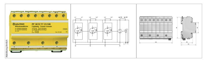
Vierpoliger Kombi-Ableiter für 3-phasige TT- und TNS-Systeme. Der Einsatzort des PowerPro BCD ist die Hauptverteilung vor oder nach dem Zähler. Er kann entsprechend dem Blitzschutzzonen-Konzept nach VDE 0185-305-1-4 (IEC DIN EN 62305 Teil 1-4) an den Schnittstellen 0A bis 2 universell eingesetzt werden
