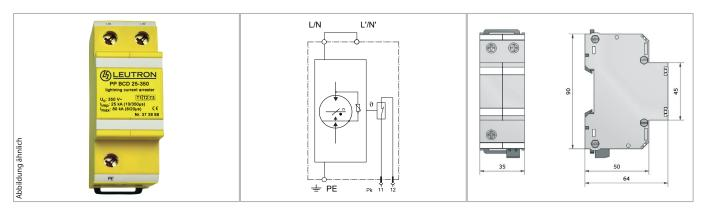
Einpoliger Ableiter zum Schutz von Niederspannungs-Verbraucheranlagen im Industrie-, Gewerbe- und Wohnbereich vor Blitz- und transienten (Schalt-) Überspannungen. Einpolige SPDs werden in 1-phasigen TN-Netzen eingesetzt, wo der N-Leiter nicht geschützt werden muss.
