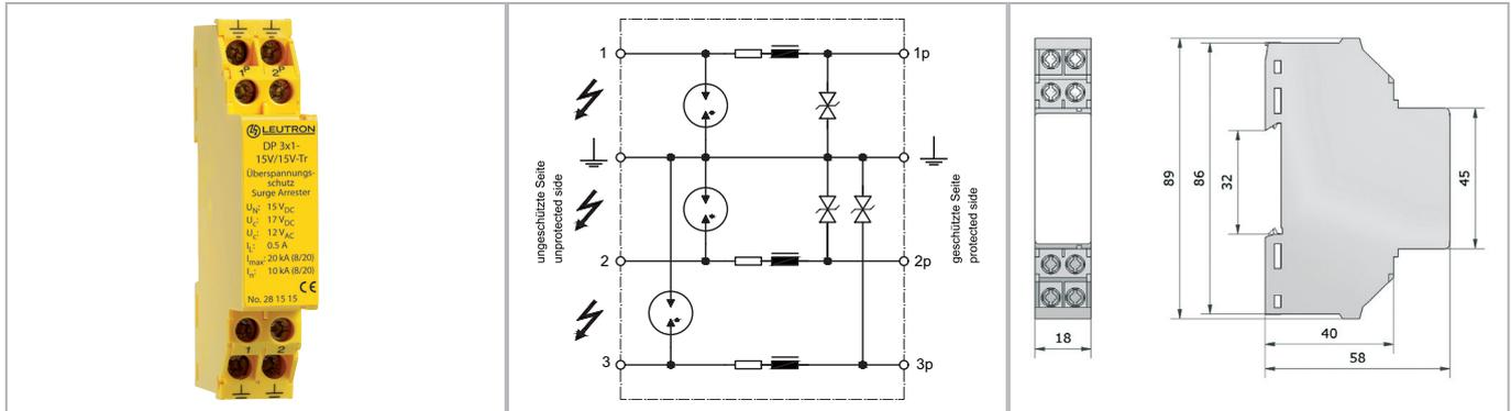
EMV-Filter kombiniert mit Überspannungsschutz für Daten- und Signalleitungen gewährleisten einen reibungsfreien Betrieb von empfindlicher Elektronik auch in rauen Umgebungen.
