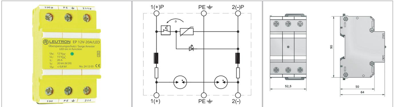
**Zweipoliger Überspannungsschutz bis 20 A Betriebsstrom in Durchgangsverdrahtung, sowie Abtrennung ohne Betriebsunterbrechung. Ein sehr niedriger Schutzpegel ermöglicht den Einsatz auch als SPD Typ 3.**
