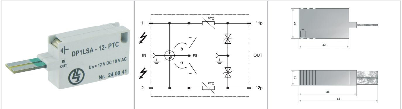
Überspannungsschutz für Signal- und Datenleitung im MSR-Bereich. Überspannungsschutzstecker für 1 DA mit Überstromschutz (PTC) und Fail-safe Kontakt für LSA-Trennleisten.
