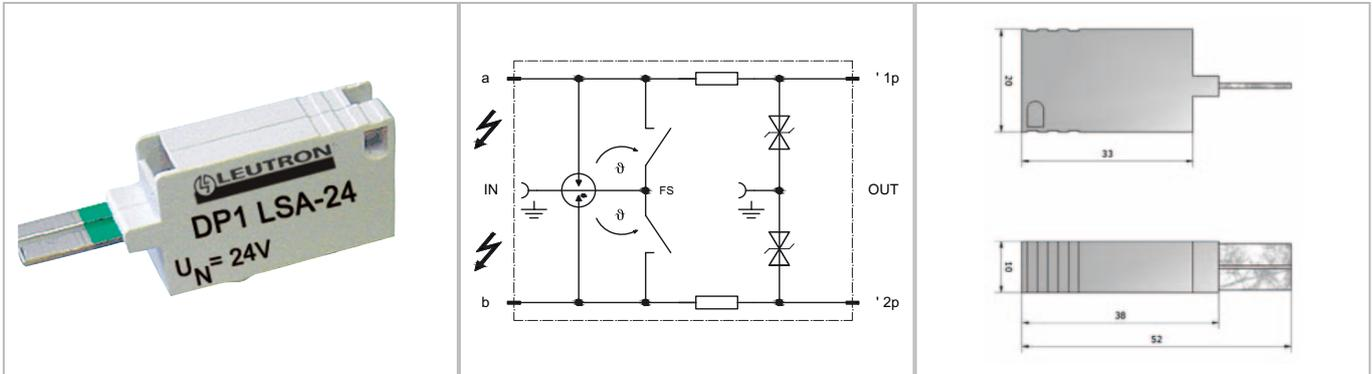
**Überspannungsschutz-Modul für Doppeladern in LSA-Trennleisten im MSR-Bereich. Das Gerät dient zum Grob- und Feinschutz in LSA-Systemen der Bauform 2. Überspannungsschutzstecker für 1DA mit Fail-Safe-Kontakt.**
