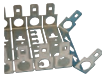
LSA 2/10-MW10-25/22 (Art.-Nr. 24 01 10) Montagewanne 10x 10DA (modular): Raster: 25 mm / Tiefe: 22 mm beliebig trennbar, bis zu einer Größe von 78 An- schlussmodulen lieferbar.
