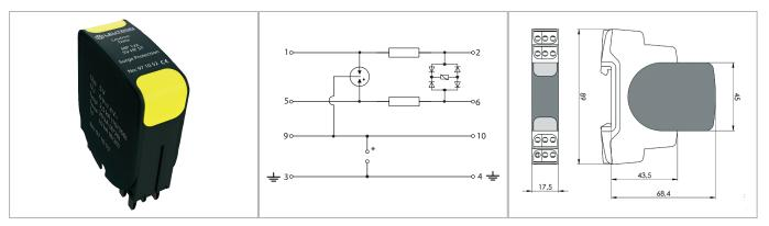
Steckmodul für den durchgängig steckbaren, zweiteiligen Ableiter für Signalkreise mit hohen Frequenzen wie Bussystemen oder Videoübertragung. Das Modul kann für Prüf- und Wartungszwecke impedanzneutral gezogen werden. Das Basisteil (Zubehör) verbleibt in der Installation, wodurch nicht in die Verkabelung eingegriffen werden muss.
