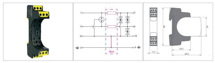
Basiselement zur Aufnahme eines MP-Moduls. Keine galvanische Trennung PE bei MP Base 1x2-R GND. Die Anschlüsse 9/10 sind über eine Brücke fest mit Montagefuß verbunden.
