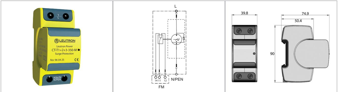
**Kombi-Ableiter mit sehr niedrigem Schutzpegel von kleiner 1,0 kV für den Einsatz zwischen L - N auf Basis gasgefüllter Funkenstrecken. Diese ermöglichen ein extrem hohes Ableitvermögen bei gleichzeitig niedrigem Schutzpegel und benötigen keine empfindliche interne oder externe Triggerelektronik.**
