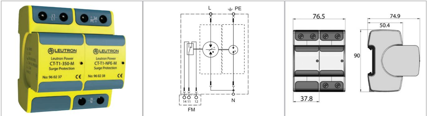
**Blitzstromableiter für einphasige TT- und TN-Systeme auf Basis gasgefüllter Funkenstrecken. Diese ermöglichen ein extrem hohes Ableitvermögen bei gleichzeitig niedrigem Schutzpegel und benötigen keine empfindliche interne oder externe Triggerelektronik.**
