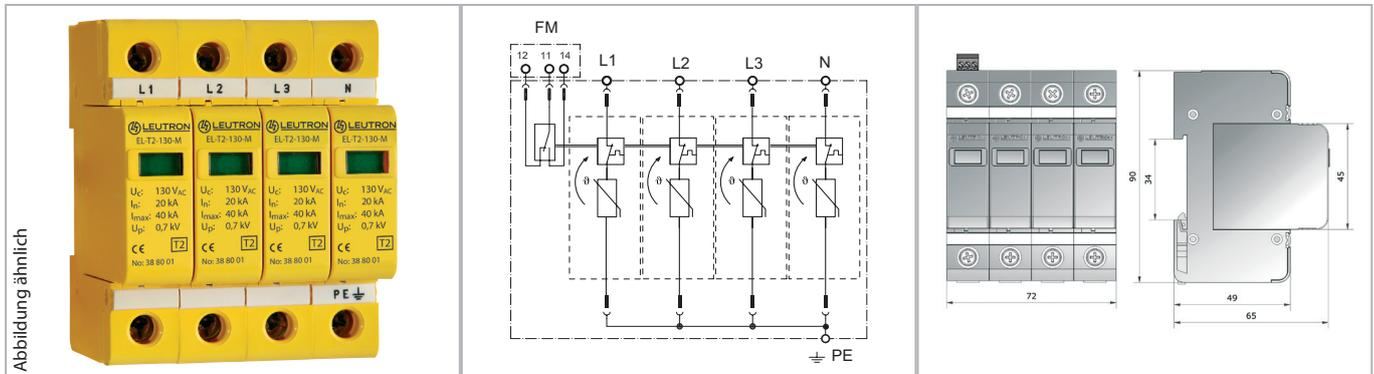
Durchgängig steckbarer Überspannungsableiter Typ 2 für dreiphasige TNS-Systeme. Kompletต์modul in 4+0-Schaltung.
