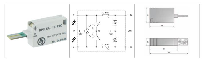
Überspannungsschutz für Signal- und Datenleitung im MSR-Bereich. Überspannungsschutzstecker für 1 DA mit Überstromschutz (PTC) und Fail-safe Kontakt für LSA-Trennleisten.
