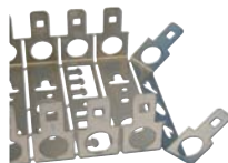
LSA 2/10-MW10-25/22 (Art.-Nr. 24 01 10) Montagewanne 10x 10DA (modular): Raster: 25 mm / Tiefe: 22 mm beliebig trennbar, bis zu einer Größe von 78 An- schlussmodulen lieferbar.
