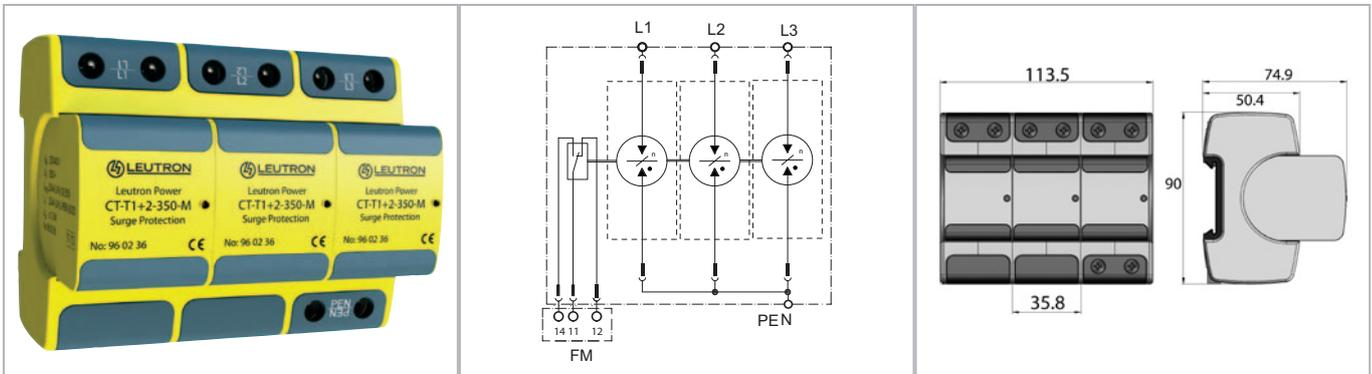
Blitzstromableiter mit sehr niedrigem Schutzpegel von kleiner 1,5 kV für dreiphasige TNC-Systeme auf Basis gasgefüllter Funkenstrecken. Diese ermöglichen ein extrem hohes Ableitvermögen bei gleichzeitig niedrigem Schutzpegel und benötigen keine empfindliche interne oder externe Triggerelektronik.
