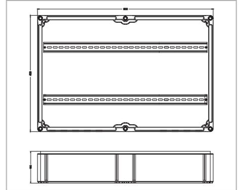
Generatoranschlusskasten mit Sicherungshaltern zur Aufnahme von DC-Stringsicherungen auf der Plus- und Minusseite. Bei PV-Anlagen zum Schutz der Wechselrichter mit sechs MPP-Trackern.
