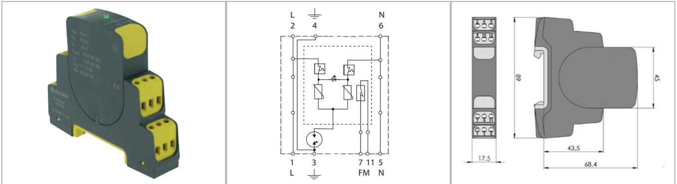
Einsetzbar nach dem Blitzschutz-zonen-Konzept an den Schnittstellen LPZ 2-3. Zweipoliger, steckbarer Überspannungsableiter Typ 3 für den Einsatz in TN-Netzen.
