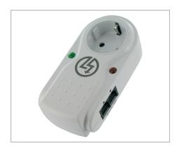
Der Zwischenstecker wird netzseitig mit einer Steckdose und auf der Geräteseite über ein Stromnetzkabel mit dem zu schützenden Endgerät verbunden. Die Schutzschaltung besteht aus einer GDT-Varistor-Kombination mit Thermosicherung, die im Schadensfall das Schutzgerät vom Stromkreis trennt. Kombinationsgerät zum Einstecken mit Überspannungsschutz von elektrischen und elektronischen Geräten für die Netzspannung 230 V. Der Einsatz erfolgt für analoge und digitale Telefonleitungen und EDV-Netzwerken.
